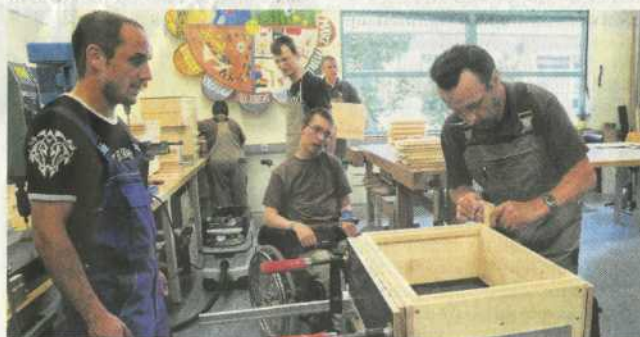
Eine neue Zarge wird zusammengesetzt. An Stellen, die hoher Beanspruchung ausgesetzt sind, wird mit festen Leisten aus Lärchenholz verstärkt. Auch Edelstahlschrauben sorgen für ein langlebiges Produkt.
